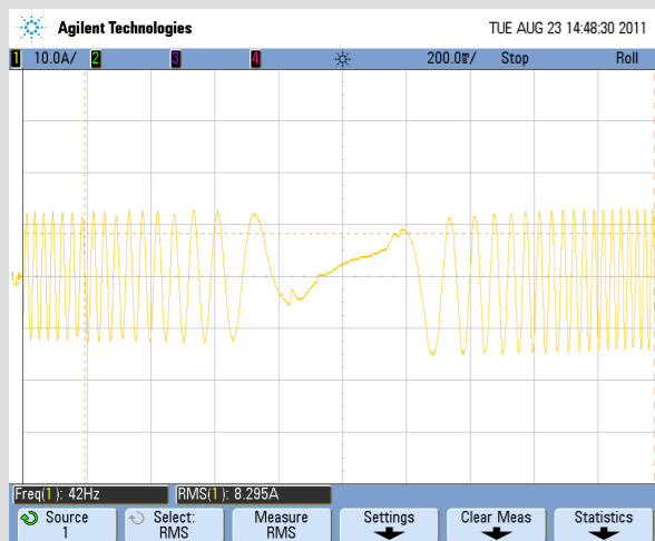
Форма тока при вращении вперед/назад в режиме векторного управления без обратной связи с полной нагрузкой на частоте 50 Гц
