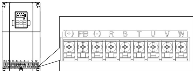
Рис. 4-4 Клеммы подключения силовых цепей
