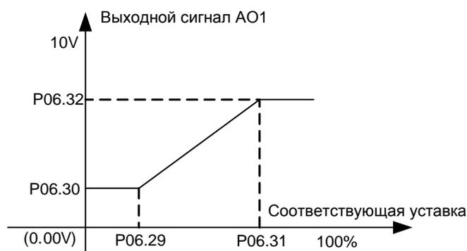
Рис 5.21 Соотношение между аналоговым выходным сигналом и соответствующей уставкой
