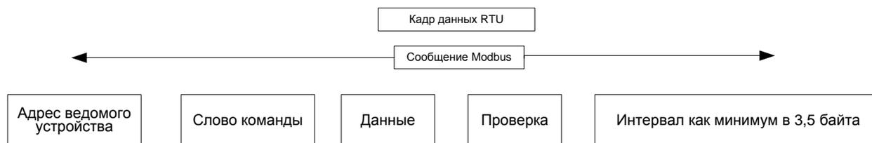
Рис В.2 Структура кадра сообщения в режиме RTU
