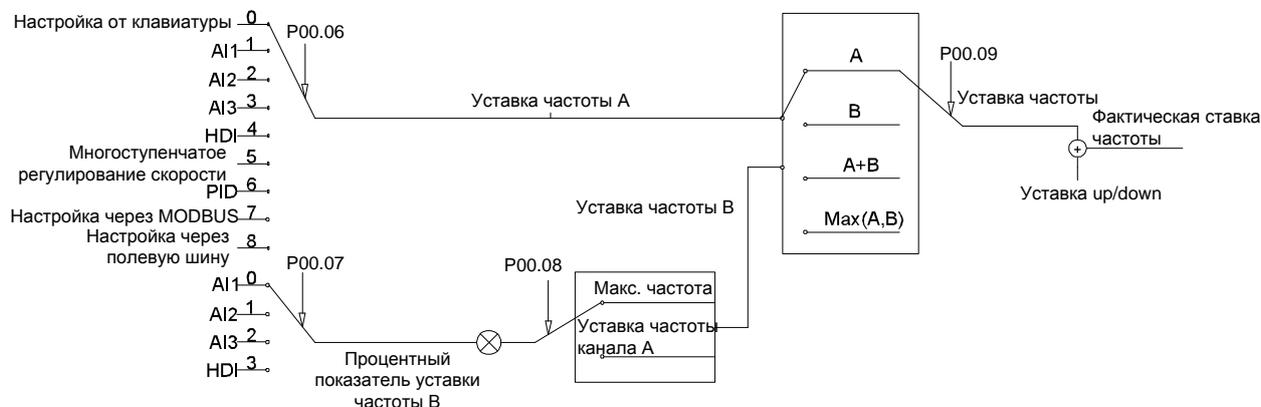
Рис 5.1 Комбинация источников задания частоты
