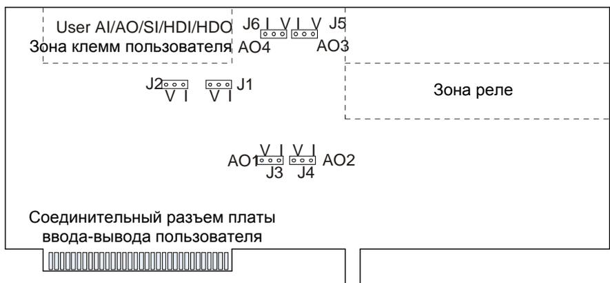
Рис 3.3 Коммутационные переемычки на плате ввода-вывода пользователя
