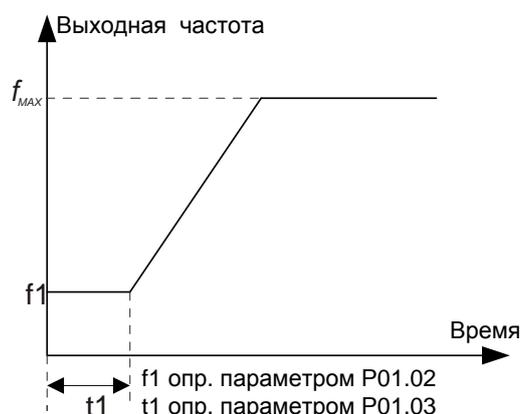
Рис 5.3 Характеристика непосредственного запуска
