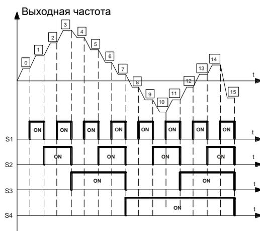
Рис 5.29 Действие режима многоступенчатого регулирования скорости
