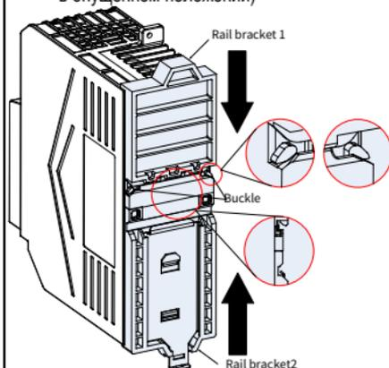
Шаг 4 Установите ПЧ с кронштейнами вертикально на DIN-рейку и надавите на фиксатор из листового металла вверх, чтобы он плотно защелкнулся на рейке.
