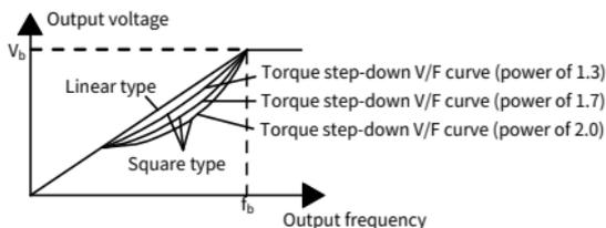
**Примечание:** На рисунке,  $V_b$  – номинальное напряжение двигателя, а  $f_b$  – номинальная частота двигателя.
