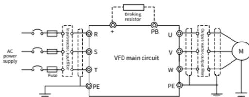
**Примечание:** Плавкие предохранители, тормозные резисторы, входные стабилизаторы, входные фильтры, выходные стабилизаторы и выходные фильтры относятся к дополнительным деталям. Подробнее см. в Приложение D Периферийные комплектующие.
