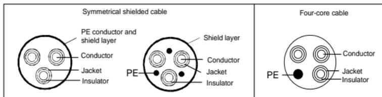
Рис. 4-3 Поперечное сечение кабеля
