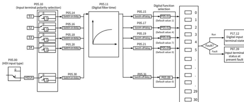
**Примечание:** Две разных многофункциональных входных клеммы не могут быть сконфигурированы с одной и той же функцией.
