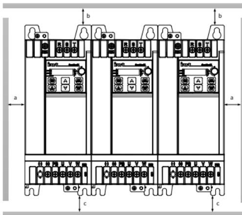
**Примечание:** При установке рядом температура окружающей среды не должна превышать 40°C.
