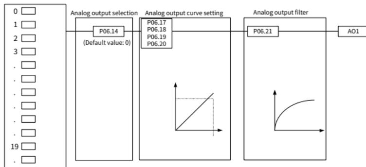
Описание выходных отношений AO1 (минимальное и максимальное значения выходного сигнала соответствует 0,0% и 100,00% от аналогового выходного сигнала по умолчанию. Фактическое выходное напряжение соответствует фактическому проценту, который можно задать с помощью функциональных кодов). Функции выходов описаны ниже:
