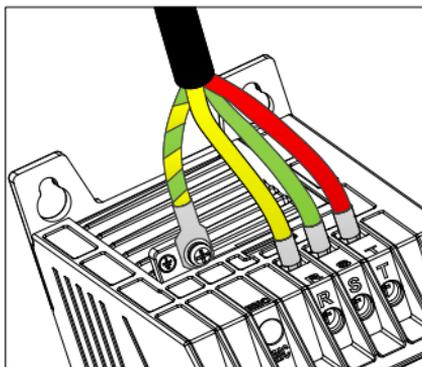
Шаг 2 Подсоедините желто-зеленый заземляющий провод кабеля двигателя к клемме заземления ПЧ, а трехфазный кабель двигателя к клеммам U, V, W и закрепите.
