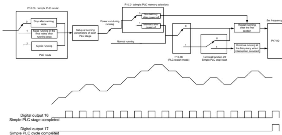
Если для установки частоты выбран простой ПЛК, необходимо установить P10.02–P10.33, чтобы определить рабочую частоту и время выполнения каждого шага. Схема выглядит следующим образом:
