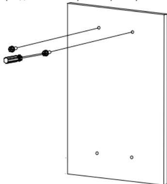
Шаг 2 Закрепите конец ПЧ с грушевидным отверстием двумя предварительно ввернутыми винтами.
