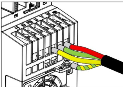
Шаг 3 Подсоедините тормозной резистор с кабелем и другие дополнительные детали в указанные места. См. раздел 4.3.1 Выбор кабеля.
