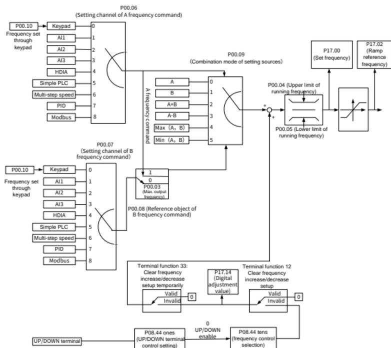
При установке P05.01/P05.02 на 10/11 S1/S2 являются клеммами UP/DOWN. При замыкании S1/S2 задание частоты будет быстро увеличиваться/уменьшаться со скоростью, определенной P08.45/P08.46. Схема представлена ниже:
