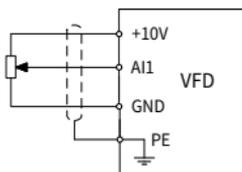
Рис. 4-15 Подключение экранирующего слоя РЕ
