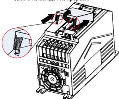
Шаг 2 Поднимите крышку и вытяните ее, немного наклонив.
