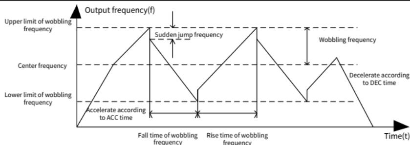
Плавающая частота = Центральная частота (задание частоты) x Амплитуда плавающей частоты P08.15
