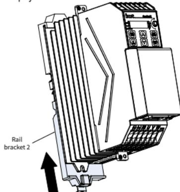
Шаг 3 Закрепите кронштейны для DIN-рейки 1 и 2. (Убедитесь, что зажим защелкнулся, а фиксатор из листового металла находится в опущенном положении)
