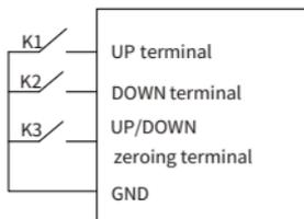
Клемма для очистки настройки увеличения/уменьшения частоты может очистить значение частоты вспомогательного канала, установленного с помощью **UP/DOWN**, таким образом, восстанавливая частоту, установленную основным каналом команды установки частоты.
