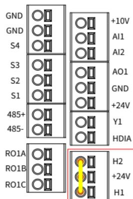
Рис. Е-2 Схема подключения функции STO
