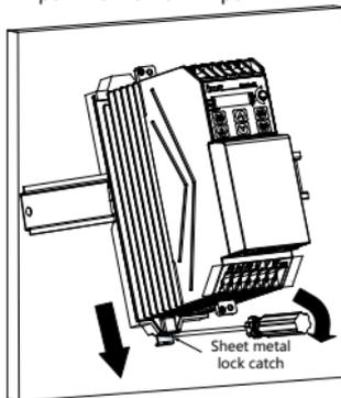
Шаг 2 Вдавите зажим в середине кронштейна для DIN-рейки внутрь, а затем вытяните кронштейны 1 и 2.
